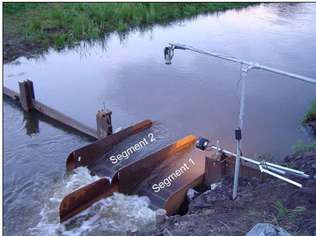
figuur 2.1 Het stuwgedeelte van de FishCounter. De stuw bestaat uit twee segmenten. Van elk segment wordt het aantal passerende vissen apart bijgehouden.
