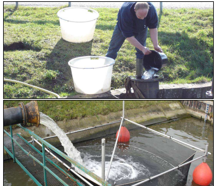
Figuur 2. (Links) Vis wordt handmatig door het opvoerwerk gevoerd en (recht) de vis wordt aan de andere zijde met een Noors leefnet opgevangen.
