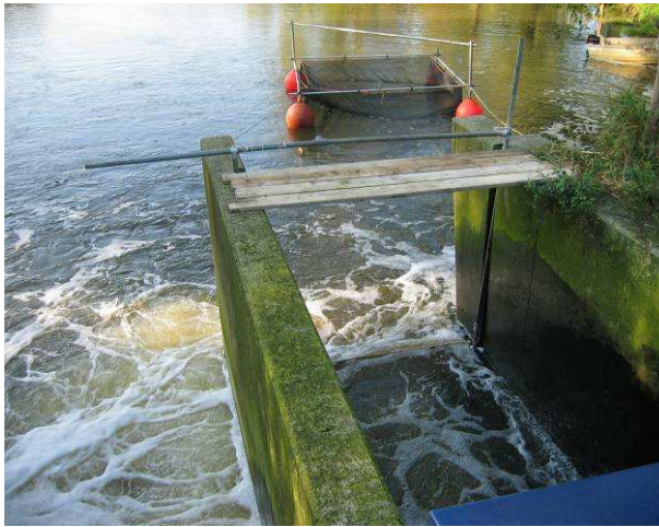
figuur 2.4 Opstelling vangtuig bij de vijzel.
