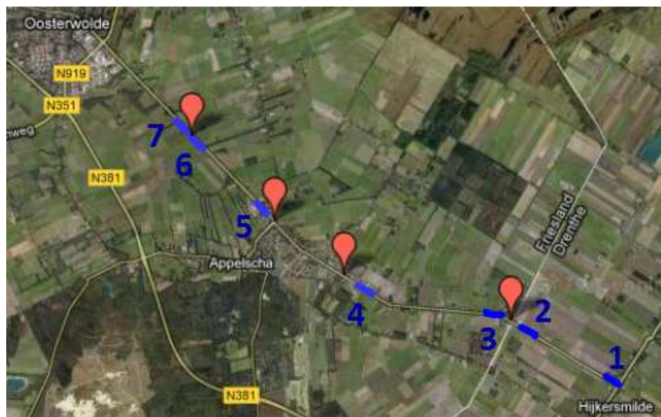
figuur 2.1 Overzicht van de bemonsterde trajecten en sluizen in de Opsterlandse compagnionsvaart. De blauwe lijnen geven de bemonsterde trajecten weer en de rode ballonnen de sluizen.
