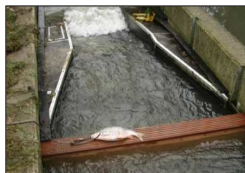
figuur 2.8 Passage van grote (> 65 cm, links) en kleine vis (ca. 10 cm) wordt goed door de Fish Counter vastgelegd. Het systeem wordt getest met vissen van bekende lengte (rechts).
