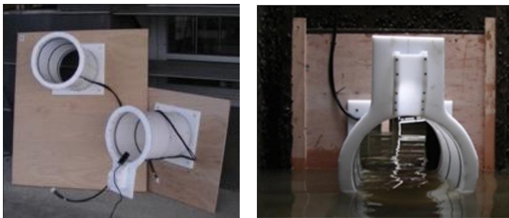
figuur 2.6 Kokercounter voor de monitoring van vispassage met een klein debiet (50-100 l/sec).
